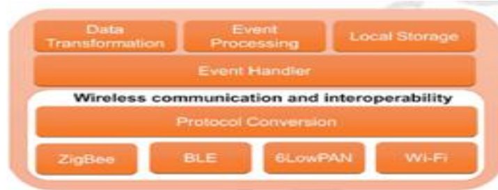
Fig 3. Fog Computing Tier modules
